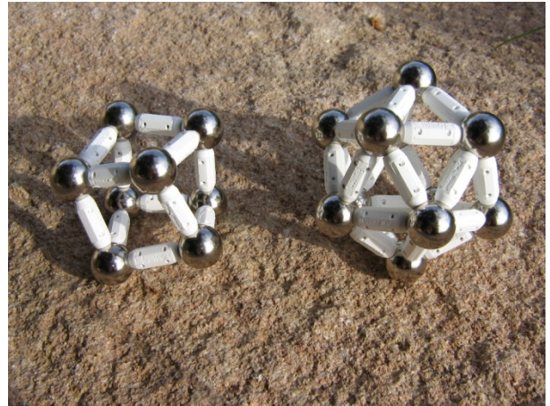
Stabilité des structures triangulées (icosahédre à droite)
